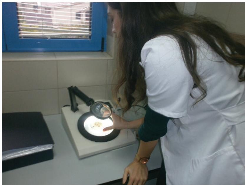
Slika 188. Aparat za brojanje kolonija mikroorganizama - lupa (Bojanić Rašović, 2020)
