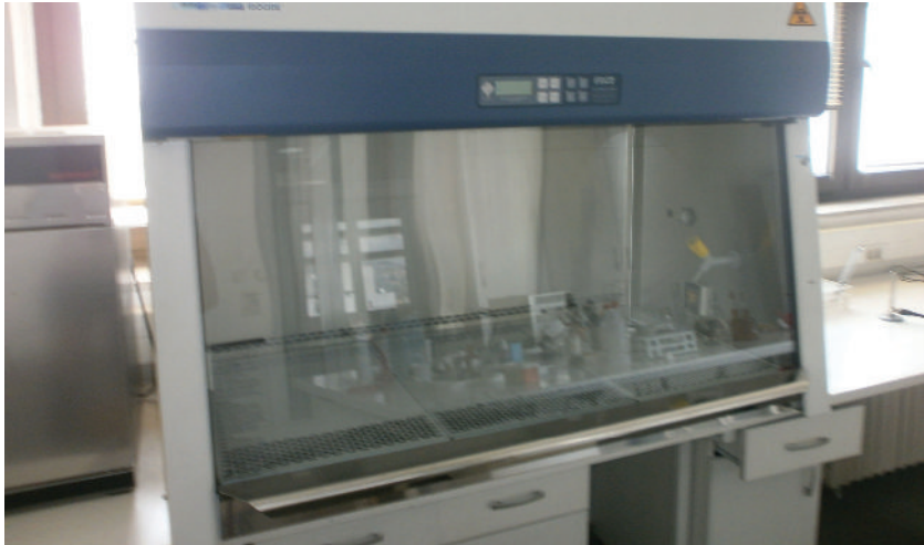
Slika 89. Biosigurnosni kabinet (laminarna komora) za rad u aseptičnim uslovima (Bojanić Rašović, 2020)
