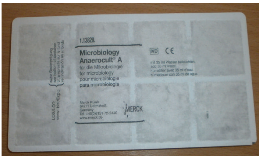
Slika 57. Kesica za stvaranje anaerobnih uslova za rast mikroorganizama (Bojanić Rašović, 2020)
