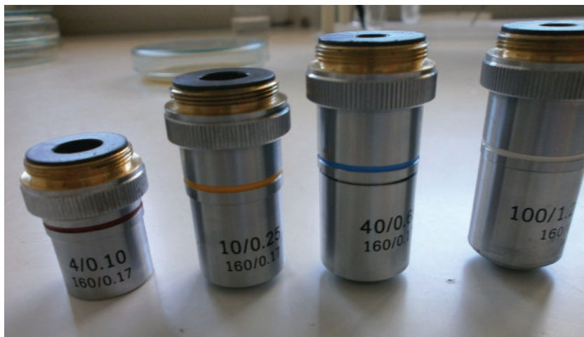
Slika 7. Suvi objektiv (uveličanja 4x, 10x, 40x) i imerzioni objektiv (100x) (Bojanić Rašović, 2020)
