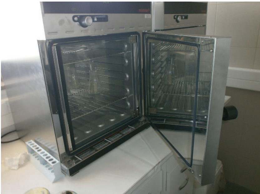
Slika 86. Unutrašnjost inkubatora za rast mikroorganizama na određenoj temperaturi (Bojanić Rašović, 2020)
