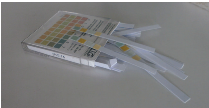
Slika 46. Indikator papir za određivanje pH podloga i rastvora (Bojanić Rašović, 2020)
