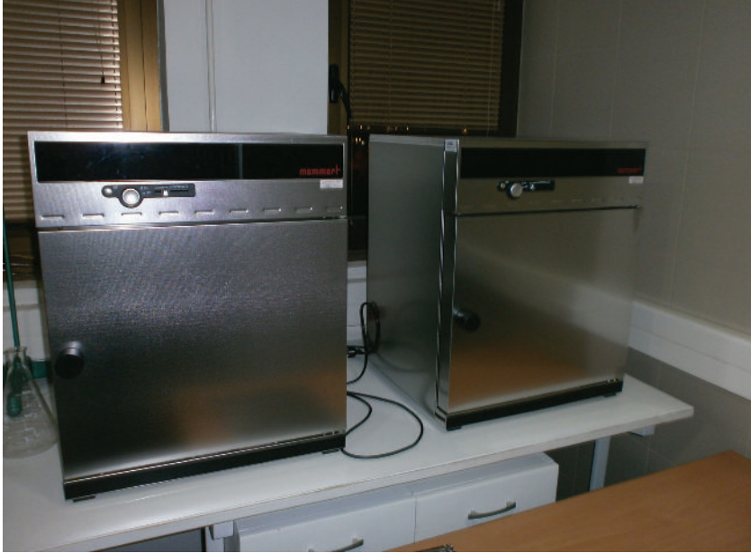
Slika 85. Termostati - inkubatori za inkubaciju zasijanih hranljivih podloga na određenim temperaturama (Bojanić Rašović, 2020)
