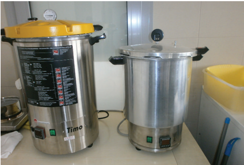
Slika 84. Mali autoklavi (mogu da posluže i kao Kohov lonac, ukoliko se poklopac ne zatvori hermetički)
