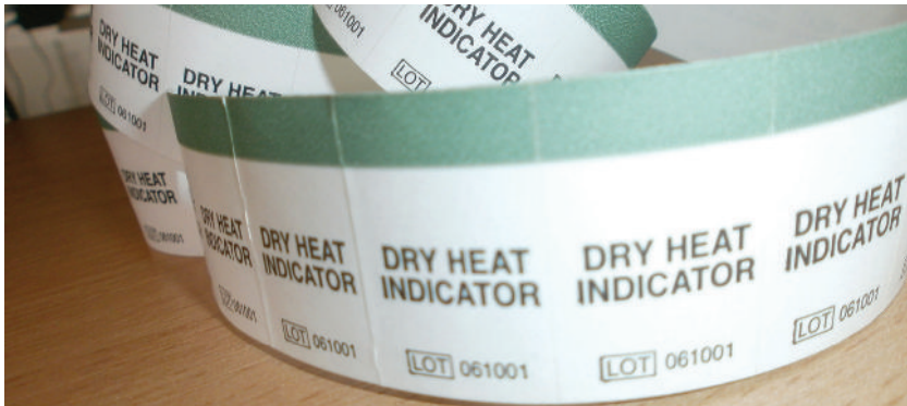
Slika 49. Indikator papir za kontrolu temperature sterilizacije (ukoliko zelena boja nakon završene sterilizacije pocrni, znak je da je sterilizacija uspješno završena) (Bojanić Rašović, 2020)
