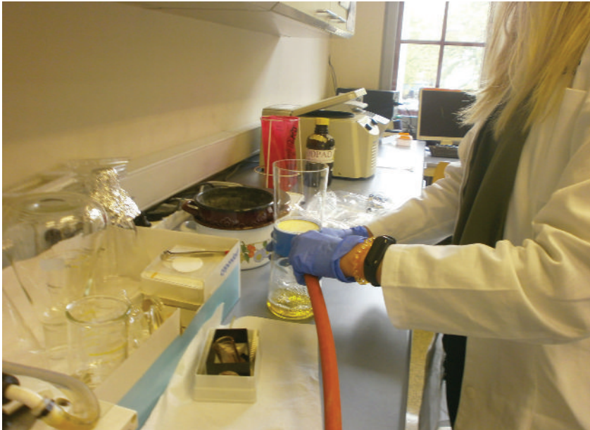
Slika 121. Filtracija tečnosti uz pomoć uređaja za membransku filtraciju (Seitz filter) (Bojanić Rašović, 2019)
